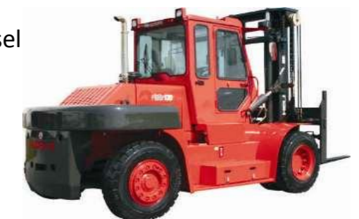
Capacité 5T à 7T, énergie GPL Capacité 5T à 10T, énergie diesel
